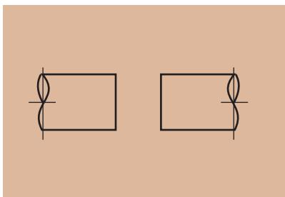
1. Удалить налипшую грязь и тщательно очистить концы трубы, попадающие в зону уплотнения.
