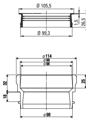
Муфта для установки унитаза, для соединения
