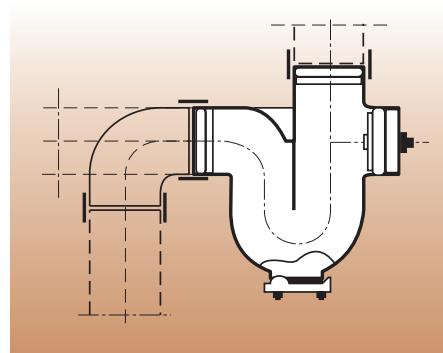
**Вертикальный подвод****Сифон водосточной трубы SML DIN 19522 – 100 – RGV**
