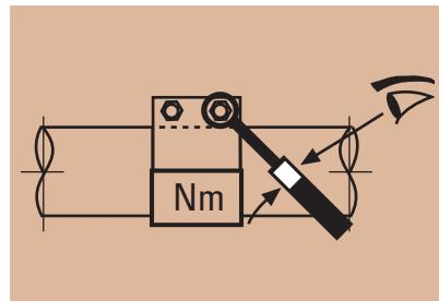
3. Надеть соединитель на концы труб и выровнять по отметкам. Равномерно затянуть винты при помощи отвертки или шуруповерта. Соединитель Connect-G нельзя вращать после того, как зубья вошли в трубу. Затянуть винты динамометрическим ключом, в соответствии с данными на заводской табличке (см. соединитель).
