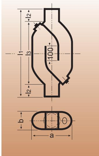
**Сифон водосточной трубы SML DIN 19522 – 100 – RGV**
