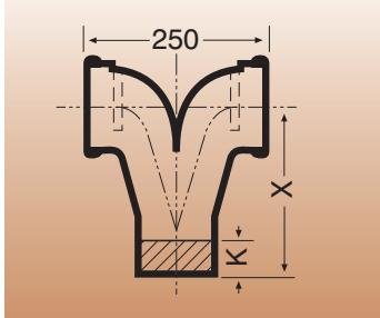
**SML-W Колено SML для унитазов с отводом**
