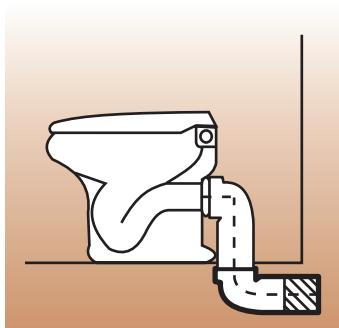
2. Напольный унитаз с горизонтальным выпуском. Подключение унитаза к чугунному соединительному колену при помощи пластикового соединительного колена 90° для унитазов.
