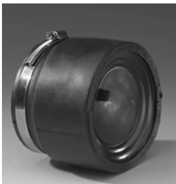
При помощи соединителя EK Fix компании Düker к сети SML от DN 50 до DN 125 могут просто и безопасно подключаться соединительные трубопроводы и отводные штуцеры из таких материалов, как полипропилен по стандартам DIN EN 1451-1 и DIN 19560-10 и ПЭ-HD по стандартам DIN EN 1519-1 и DIN 19535-10. Двойное манжетное уплотнение и большая глубина посадки способствуют высокой устойчивости соединительной трубы.
