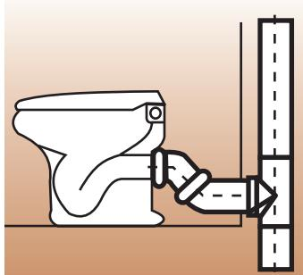
3. Напольный унитаз с горизонтальным выпуском. Подключение к стене к чугунному тройнику 88° вертикальной системы.
