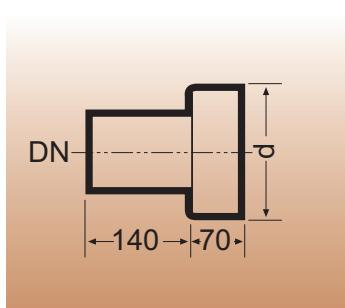
**Переходник SML DIN 19522 – 200 – E соединяющий керамические трубы с чугунными**
