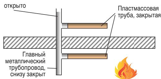
Одно из возможных расположений огневого испытания для допуска решений для смешанной инсталляции.
