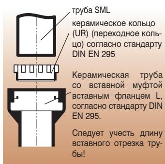
**Труба SML**, соединенная с керамической трубой (нормальная толщина стенки) без подготовленного уплотнителя DN 100 до 300
