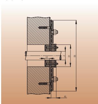
**Doyma Curaflex® Quick IN A уплотнительный вкладыш для защиты от безнапорной воды**
