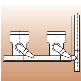
8. Напольный унитаз с бачком ёмкостью 4,5 или 6 литров, с пластиковым коленом DN 90, с соединителем Düker EK Fix DN 80 и тройником 45° DN 80.
