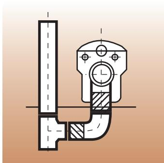
7. Подключение подвесного унитаза при помощи чугунного соединительного колена, колена SML 88° с удлиненным рукавом и пластикового соединительного выпуска.
