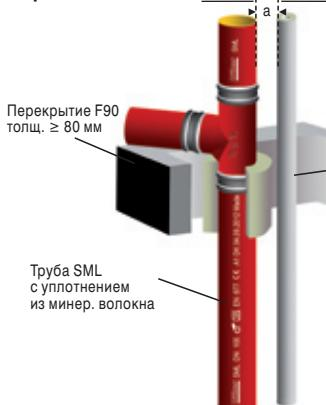
Расстояние  $a \geq 5$  см между трубой SML и изоляцией распределит трубопровода согласно MLAR 4.1.3
