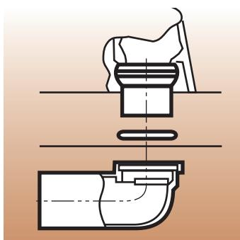
5. Элементы соединения: пластиковый выпуск унитаза, чугунное соединительное колено для унитаза со специальным раструбом и резиновым уплотнительным кольцом.
