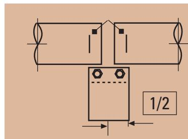
2. Отметить половину длины соединителя на каждом из концов трубы.
