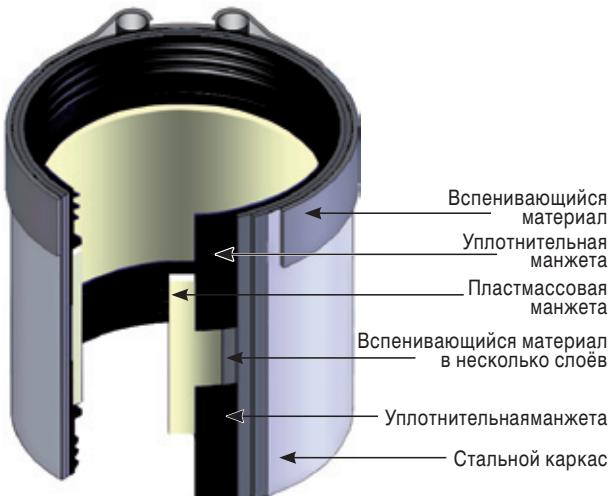
Внутри противопожарного соединителя чугунный трубопровод прерывается пластмассовой трубой. Вокруг трубы соединитель содержит высококачественный вспенивающийся материал, который при воздействии высокой температуры сильно увеличивает свой объём. Благодаря этому в случае пожара труба по всему диаметру полностью закрывается.
