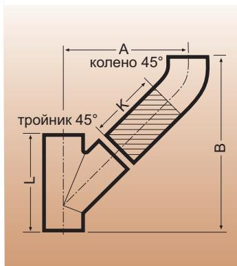
**Соединение из колен и тройников SML (колено со стороной 250 мм)**
