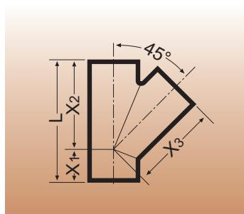
С введением стандарта DIN 19522: 2000-01 произошли изменения размеров некоторых фасонных частей, например, таких как тройники 45° и крестовины. Поэтому размеры таких фасонных частей с более поздней датой изготовления могут отличаться от указанных здесь величин.
