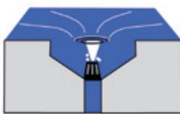
Воронка для вакуумной системы Aquaperfect, со специальной сетчатой насадкой для исключения подсоса воздуха в систему при достижении расчетного значения дождевой воды
