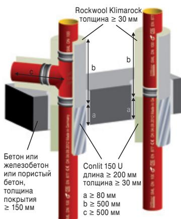
Эти перегородки могут быть вмонтированы в подходящее сверлённое отверстие без заливки; в противном случае оставшуюся щель заливают бетоном или цементным раствором.
