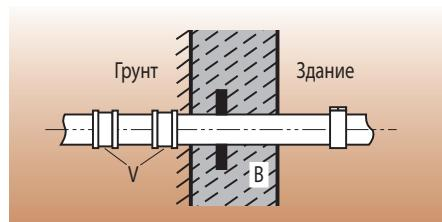
V = соединитель SVE для соединения труб в грунте, B = водонепроницаемый бетон
