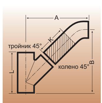
**Соединение тройника SML 45° и колена SML 45° (колено со стороной 250 мм)**
