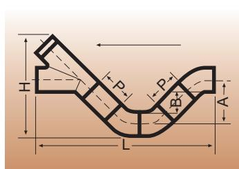
**Труба водосточная, без растрюба, без прочистного отверстия**
