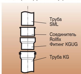
**Труба SML из различных трубных материалов (гладкий конец)**
