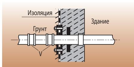
Труба SML с фланцем для крепления к стене
