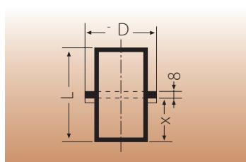
**Труба опорная для стояков SML DIN 19522 – 100 FS**
