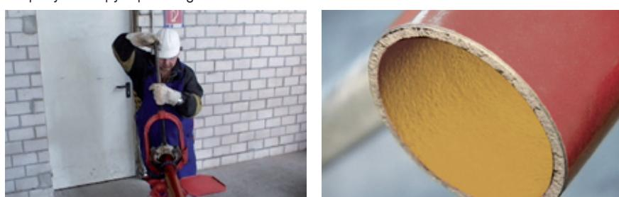
Чугунные канализационные трубы производства компании Dürker поставляются стандартными отрезками длиной 3 м. Эти трубы можно разрезать перед укладкой, в соответствии с требуемыми размерами. Очень хорошим инструментом для этого является труборез Exact PipeCut, например, Exact PipeCut 170E. Более подробная информация по адресу [www.exacttools.com](http://www.exacttools.com).
