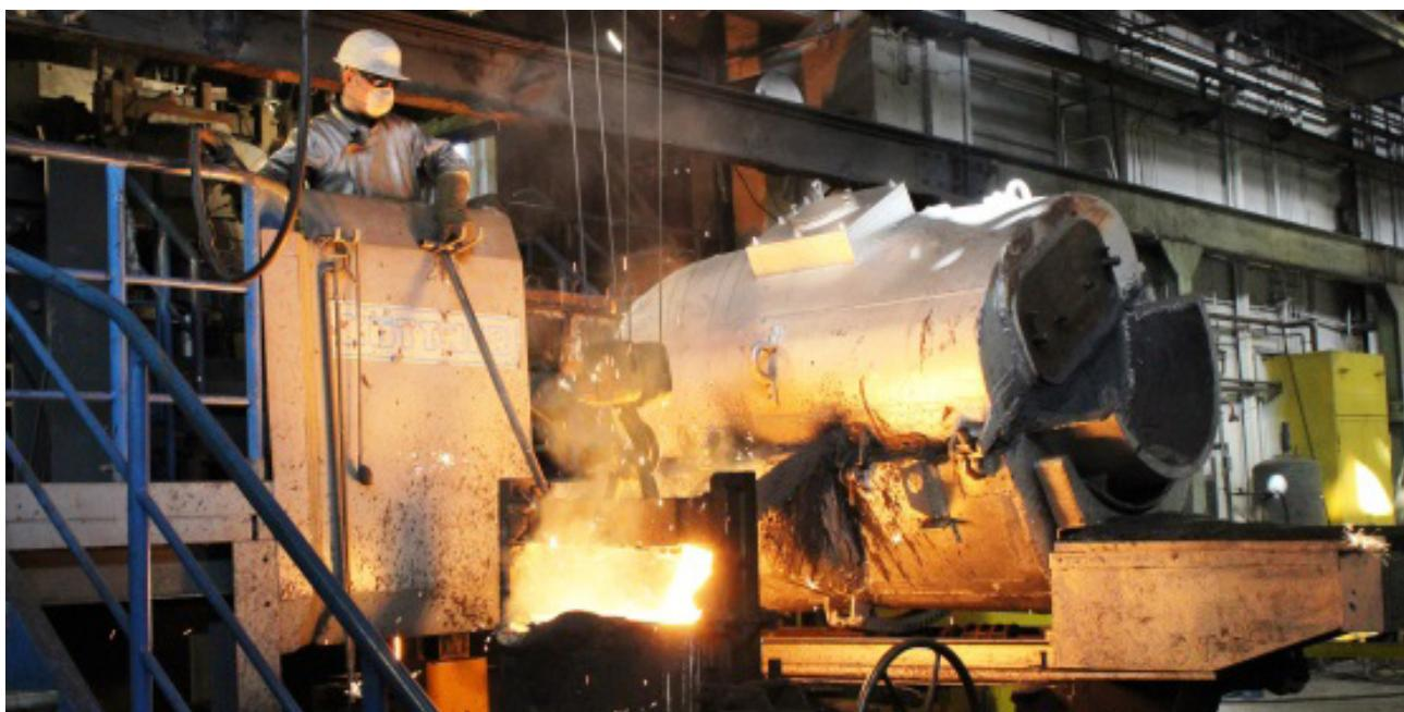
Процесс плавки: забор жидкого чугуна из вагранки
