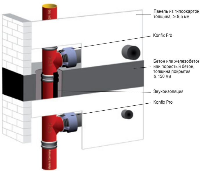
**Расстояния:** Вы можете использовать величины расстояний для пристенной конструкции и для других трубопроводов, расположенных за пристенной конструкцией, из актуальной версии стандартного сертификата об испытаниях в строительстве (abZ) или из документации фирмы Doyma.
