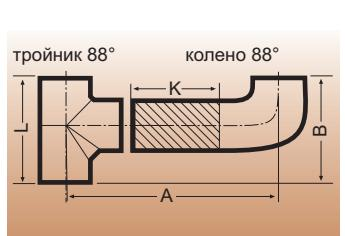
**Соединение тройника SML 88° и коленом SML 88°**
