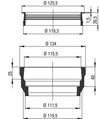
Муфта для установки унитаза, для соединения
