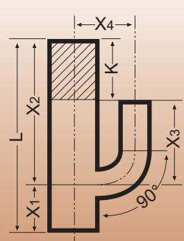
Тройник SML с параллельным рукавом DIN 19522 – 100 x 80 P
