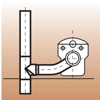
6. Подключение подвесного унитаза при помощи чугунного соединительного колена и пластикового выпуска.
