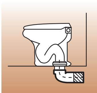
1. Напольный унитаз с закрытым вертикальным выпуском. Подключение унитаза к чугунному угловому колену при помощи пластикового соединителя для унитазов.
