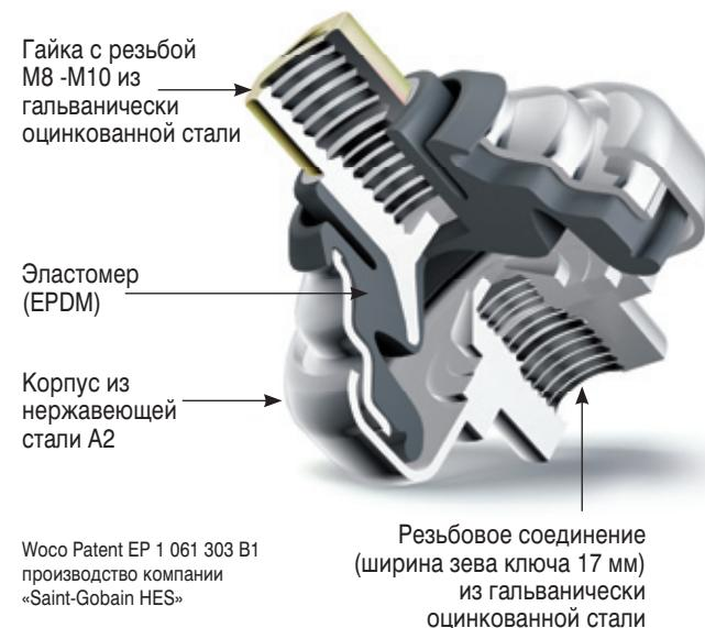
Звуковой изолятор можно любым концом привинтить к хомуту для крепления трубы.
