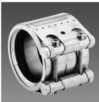
Connect-F: не устойчив к осевым нагрузкам; выдерживает давление до 10 бар при соответствующем креплении трубы с неподвижными опорами, гасящими осевые нагрузки.
