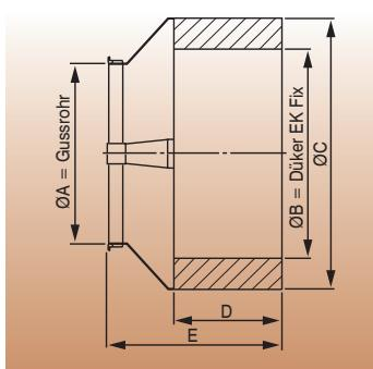
Противопожарная система перегородок для монтажа с помощью соединителя EK Fix компании Düker для смешанных инсталляций (чугунная водосточная труба/пластмассовый соединительный трубопровод).
