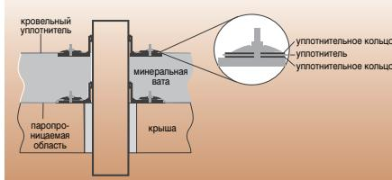
Для каждого кровельного прохода необходимо использовать два уплотнителя. Материал, из которого должно быть изготовлено уплотнительное кольцо (ЭПДМ или НБР), следует согласовать с производителем кровельного покрытия. Уплотнительные кольца не входят в комплект поставки кровельного водовода.
