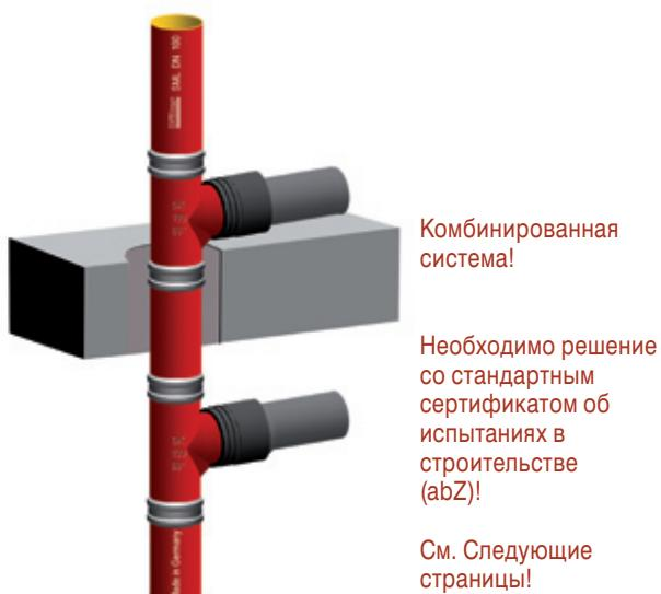
Некомбинированная система согласно Немецкому институту строительной техники, бюллетеню 2012-2 – MLAR или стандартный сертификат об испытаниях в строительстве (abP)! В соединительном трубопроводе минимум 50 см. чугуна
